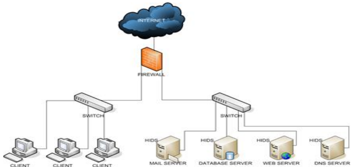
2-rasm. Hostga asoslangan suqulib kirishlarni aniqlash tizimi(HIDS) arxitekturasi
